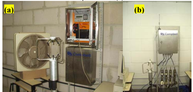
Figura 2. Anemômetro ultra-sônico (a) e Sistema de medição de esforços mecânicos (b)
