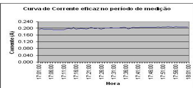
Figura 12. Valor eficaz de corrente obtido na amostra 5 das lâmpadas fluorescentes compactas
