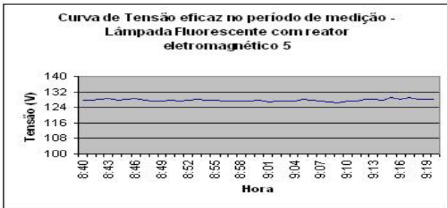
Figura 1. Valor eficaz de tensão aplicada em lâmpada fluorescente convencional com reator eletromagnético da amostra 5
