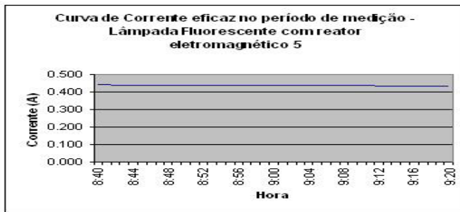
Figura 2. Valor eficaz de corrente obtido em lâmpada fluorescente convencional com reator eletromagnético da amostra 5
