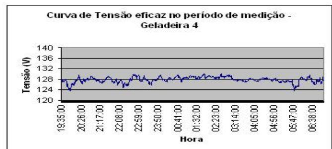
Figura 15. Valor eficaz de tensão aplicada na amostra 3 de geladeiras
