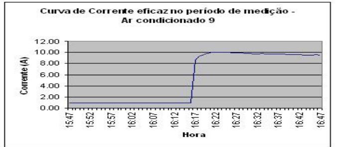
Figura 32. Valor eficaz de corrente obtida amostra 9 de aparelhos de ar condicionado
