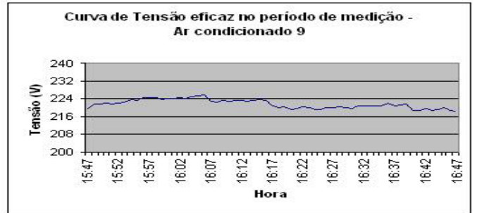
Figura 31. Valor eficaz de tensão aplicada na amostra 9 de aparelhos de ar condicionado
