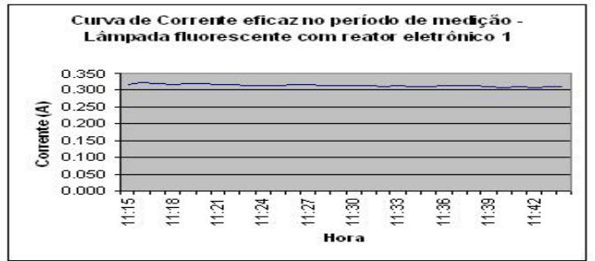
Figura 6. Valor eficaz de corrente obtido em lâmpada fluorescente convencional com reator eletrônico da amostra 1
