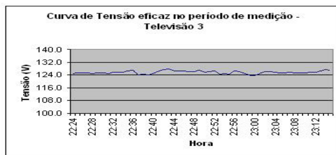
Figura 19. Valor eficaz de tensão aplicada na amostra 3 de televisores
