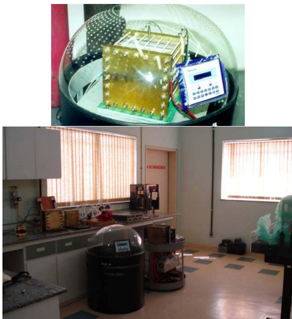
Figura 12: Célula tipo PEM no Laboratório de Hidrogênio.
