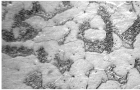
FIGURA 3 - Estrutura metalográfica do Coletor de Saída do Superaquecedor de Placas, apresentando ferrita e carbonetos esferoidizados no estágio C de degradação. Ataque: Nital 1%. Aumento: 480X.
