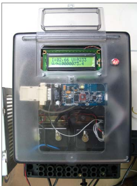
Figura 2 - Protótipo do medidor eletrônico com comunicação Bluetooth.
