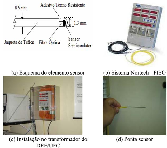
Figura 3. Sistema de aquisição de dados de temperatura com sensor de fibra óptica – sistema FISO – transformador do DEE/UFC.
