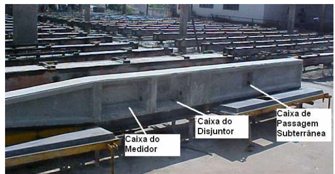
Figura 5 – Padrão Compacto Trifásico em fabricação
