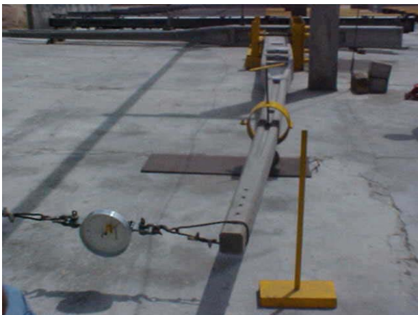
Figura 4. Ensaio de ruptura em protótipo tipo 1
