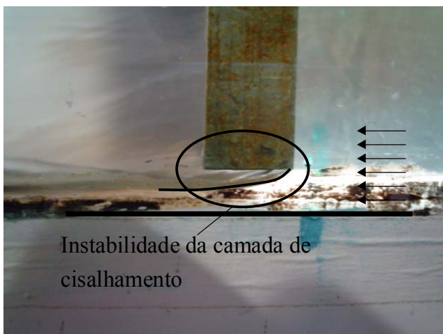
Figura 5: Fotografia do escoamento sob a comporta para terminal retangular – Q=23 l/s, \delta=20 mm, jato livre
