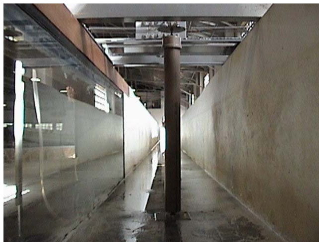
Figura 1: Aspecto da fixação elástica do cilindro no canal
