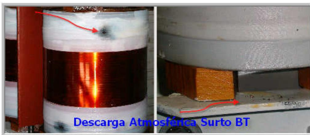
Figura 7 - Identificação da causa de avaria por descarga atmosférica (Surtos BT)
