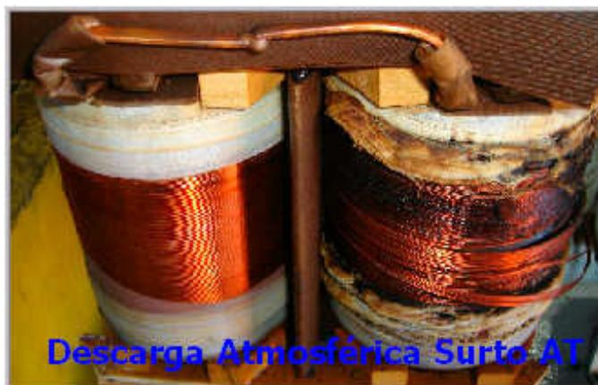
Figura 6 - Identificação da causa de avaria por descarga atmosférica (Surtos AT)
