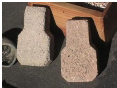
FIGURA 10 – Blocos de calçamento, preparados com resíduos de porcelana de isoladores
