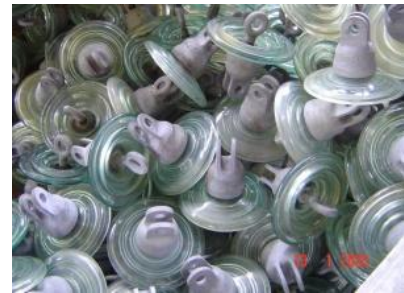
FIGURA 6 – Isoladores de vidro após a limpeza da ferragem por jateamento
