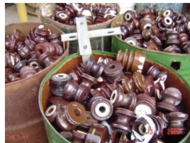
FIGURA 12 – Porcelana de isoladores separada para reciclagem
