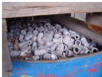
FIGURA 14 – Rosca de chumbo retiradas de isoladores e separadas para reciclagem
