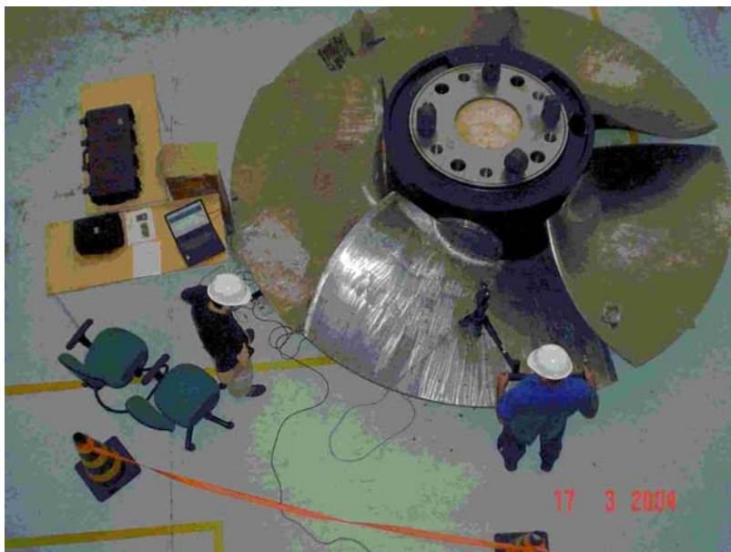
FIGURA 1 – Rotor Kaplan novo durante de medição
