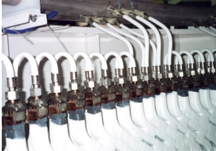
FIGURA 8: Estator completo, incluindo conexões hidráulicas
