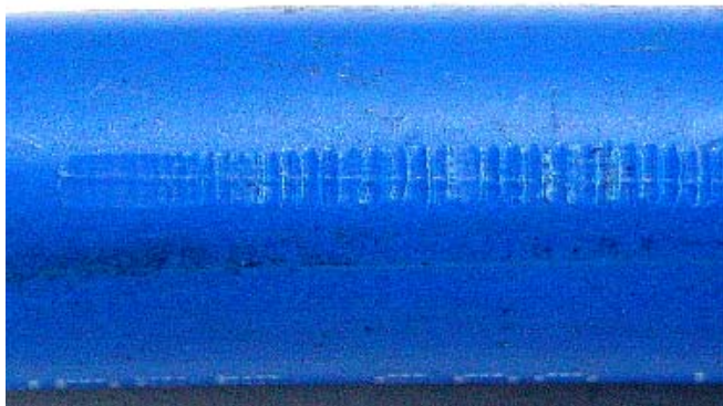
Figura 4 – Região desgastada do corpo-de-prova, após ensaio de resistência à abrasão.
