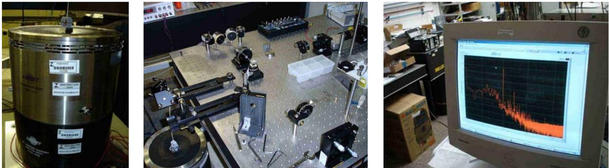
Figura 9 - Calibração no Inmetro. Da esquerda para a direita: módulo do acelerômetro montado no excitador eletromagnético, vista geral do sistema de interferometria laser e tela do sistema de calibração.
