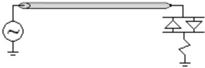
FIGURA 4 – Carga resistiva sendo alimentada por uma fonte senoidal, 60Hz, 13,8kV trifásico e linha de transmissão com 8km.
