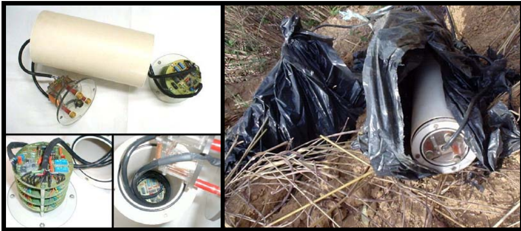
FIGURA 2 : Magnetômetro tipo fluxgate para instalação em posição vertical abaixo das LTs [5].
