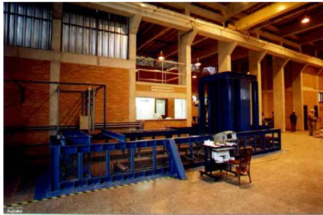
FIGURA 2 Vista Geral do Equipamento para Compactação de CCR em Laboratório
