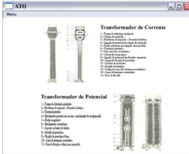
FIGURA 6 – TC e TP em corte
