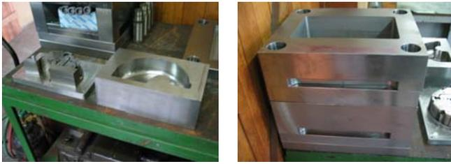
Figura 12a – Cavidade para uma das partes mecânica, 12b – base do molde de injeção da parte mecânica dos sensores
