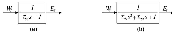
Figura 4 – Turbinas aeroderivativas tradicionais: (a) Spool simples e turbina livre e (b) Dois spools e turbina livre.
