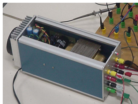
Fig. 3 – Amplificador de tensão CA trifásico desenvolvido.
