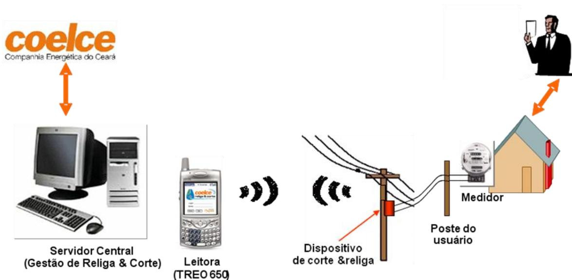
**Figura 1** – Arquitetura funcional do sistema de Religa & corte
