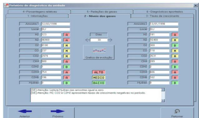
Figura 6 - Uma das telas do GASCRO mostrando duas seleções de cromatografia de um determinado transformador. Cada gás é classificado por níveis pelo programa (baixo, médio, alto)
