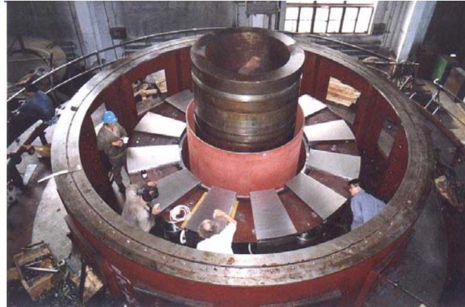
FIGURA 2 - Grande mancal de escora em teste com carga axial de cerca de 3000t. Na figura pode-se observar os segmentos do mancal e o eixo da máquina. Para operação o anel girante é montado no eixo e enche-se o recipiente de óleo.
