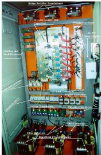
FIGURA 10 – Protótipo de 5kVA/220V do Mini-DVR
