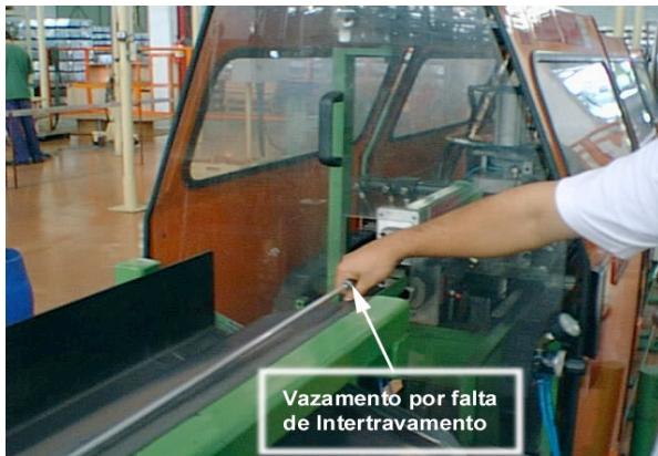
FIGURA 6. Vazamento em Máquina por falta de Intertravamento (Uso final).
