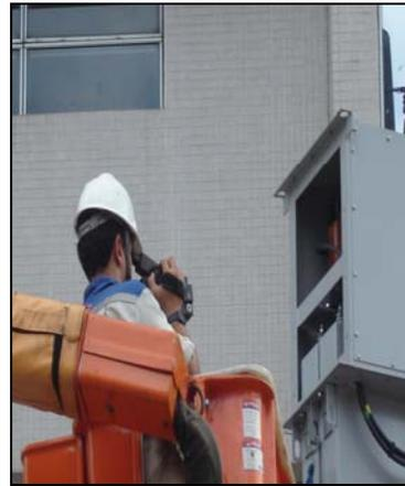
Fig. 13 - Teste de termografia
