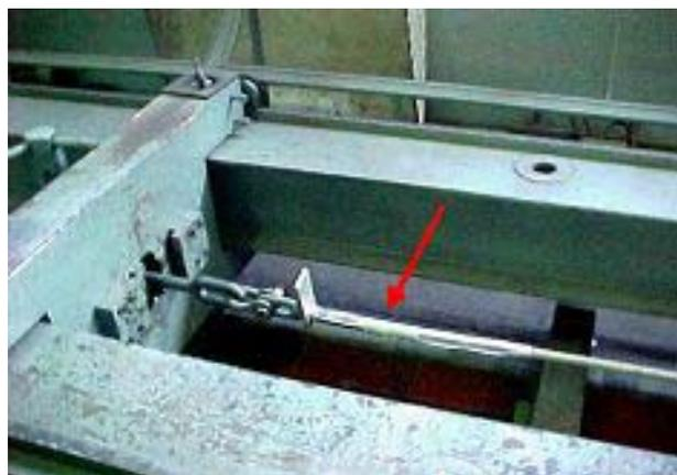
**Figura 2.** Fixação da amostra na máquina horizontal.
