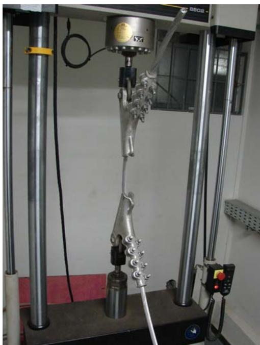
**Figura 5.** Máquina de tração longitudinal.
