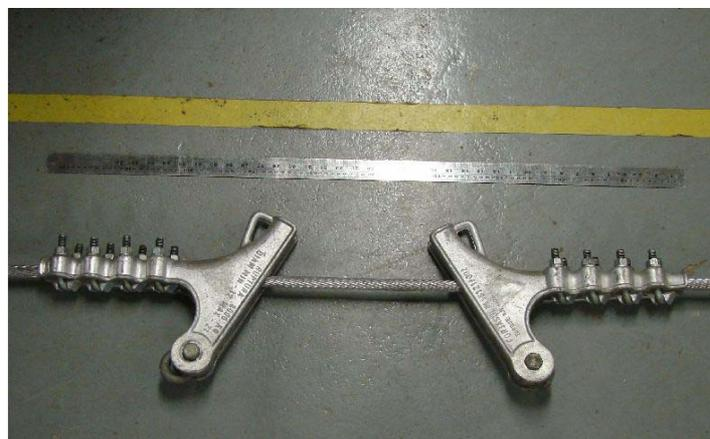
**Figura 3.** Amostra para ensaio de tração vertical.
