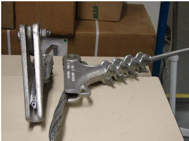
**Figura 8.** Amostra de cabo condutor rompida
