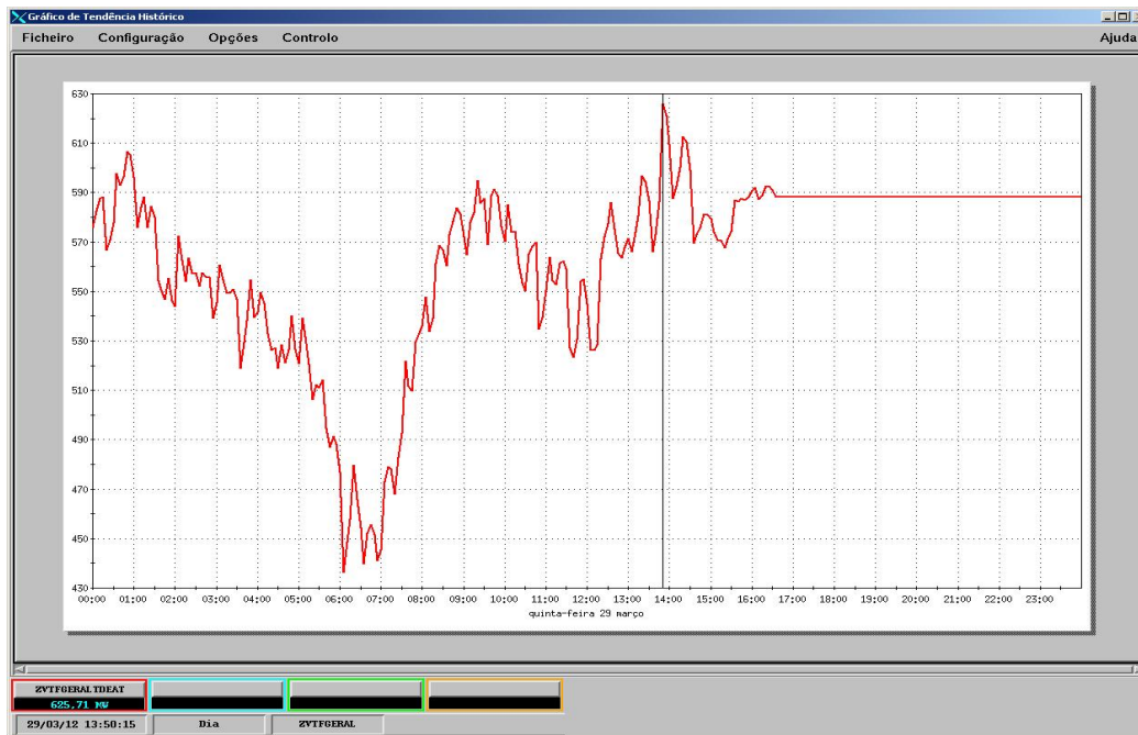
Figura 3 - MUST na interligação 138 kV Pitanga (EDP Escelsa) / Vitória (Furnas) em 29/03/2012
