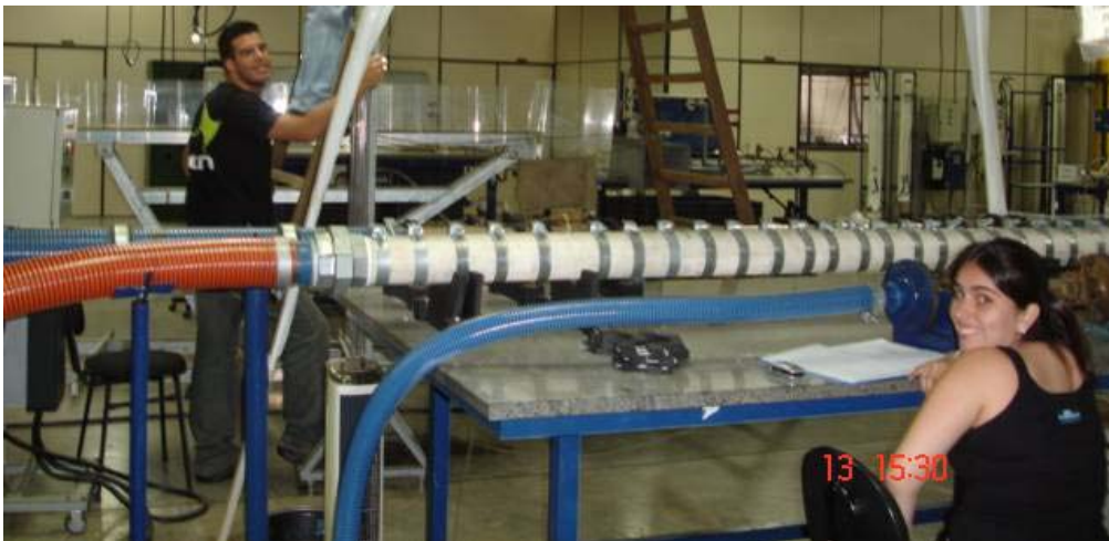
FIGURA 4: Bancada de testes preparada para início dos testes de perda de carga em condutos infestados pelo Limnoperna fortunei .
