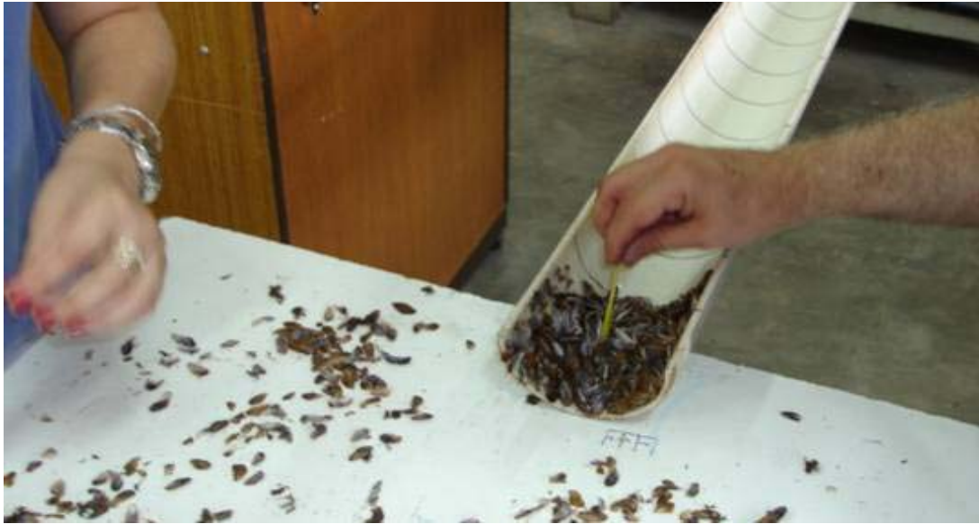
FIGURA 5: Detalhe da colagem de Limnoperna fortunei na calha da tubulação de teste.
