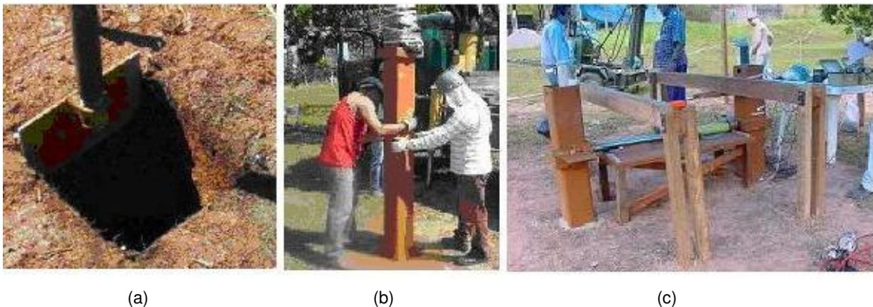
FIGURA 4 - (a) Escavação realizada com a ferramenta auxiliar para corte; (b) Instalação da estaca teste na escavação; (c) Montagem final da prova de carga.
