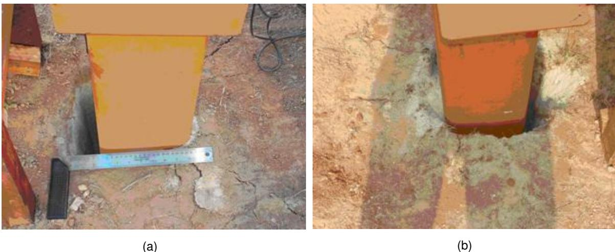
FIGURA 7 - (a) Detalhe das trincas e intumescimento do solo na parte frontal da estaca teste; (b) Detalhe das trincas e intumescimento do solo na parte frontal da estaca de reação.
