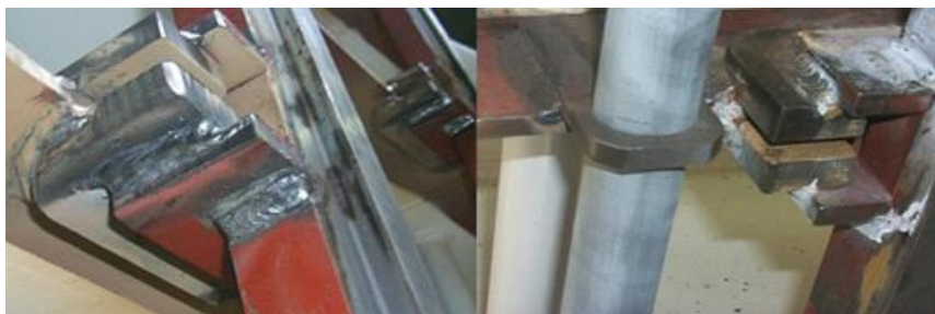
Figura 1: Sistema de guia e aperto do núcleo do estator
