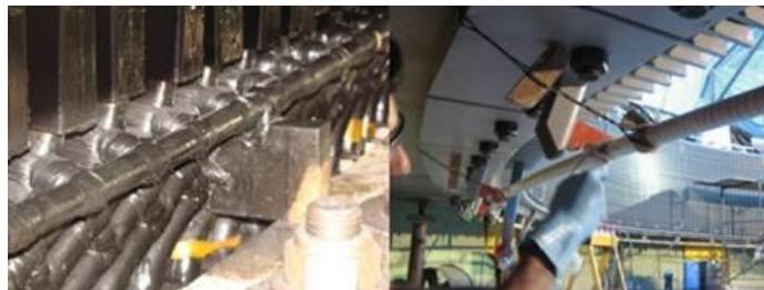
Figura 6: Suportes do anel de surto nos flanges.
