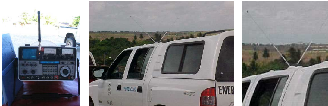
Figura 4 – Analisador de espectro empregado para medir a intensidade do sinal de TV e rádio FM, e viatura com antena do tipo interna adaptada no teto
