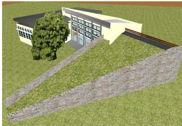
FIGURA 2 – Vista SE do Centro de Informações – Bloco Leste com Cobertura Naturada Verde e fachadas laterais revestidas de pedra, Bloco Central com fachada Sul envidraçada e Bloco Oeste com prateleira de luz
