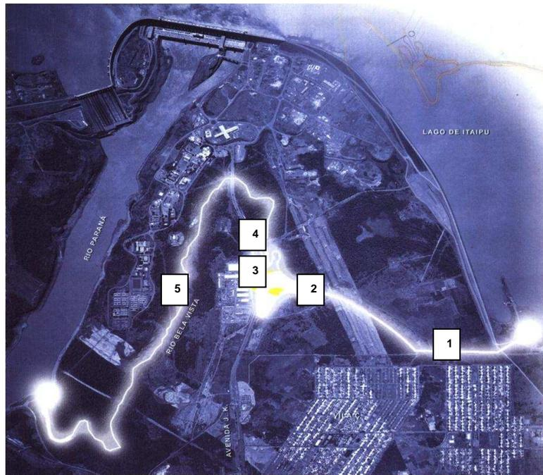
FIGURA 1 – Canal da Piracema da UHE Itaipu (números nos quadrados representam as estações fixas de radiotelemetria).
