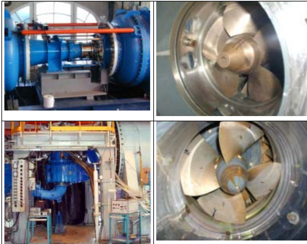
Figura 3: Plataformas de ensaios e modelos de rotores montados (linha superior: bulbo / linha inferior: Kaplan)
