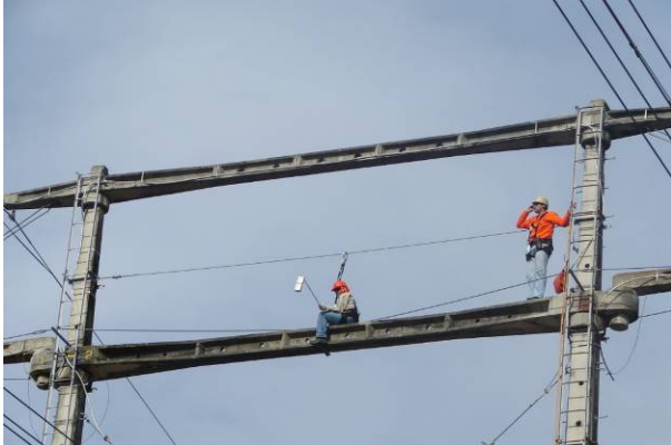
Figura 4 - Medição de campo elétrico em pontos especiais usados para calibrar o modelo computacional.
