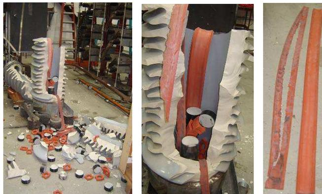
FIGURA 6 – Seções do PR B/45239-311 depois da tentativa de ensaio de tensão residual com 5 kA
