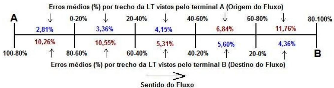
FIGURA 3 – Erros médios, por trecho da LT, vistos de cada terminal.
