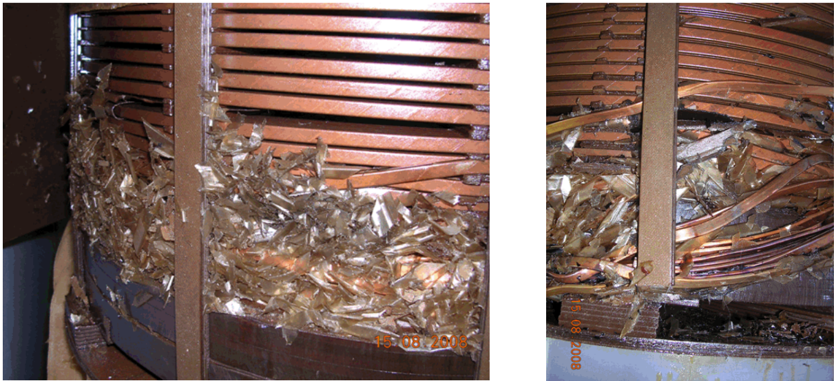
Figura 1 - Efeito sobre o reator trifásico do terciário do autotransformador
