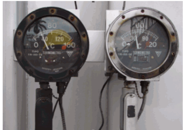
Figura 5: Temperatura dos enrolamentos e do óleo superiores a 160°C e 100 °C durante a falta
