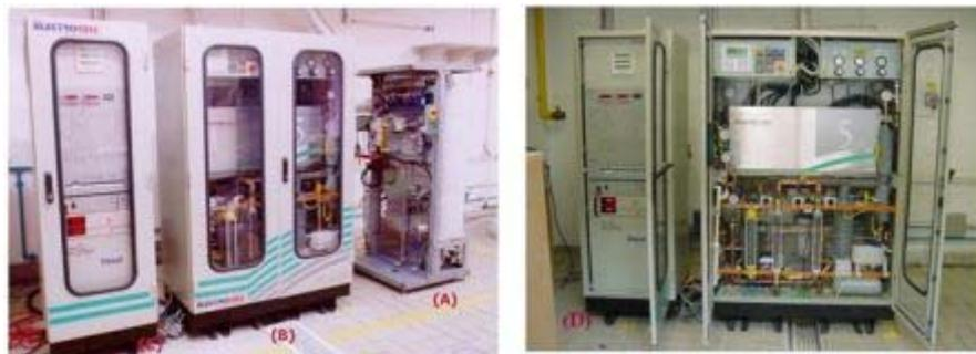
FIGURA 1 – Sistema de célula a combustível de membrana polimérica trocadora de prótons do Laboratório de Células a Combustível do CEPEL: (A) reformador de GN; (B) unidade PEMFC – 5 kW; (C) sistema de eletrônica de potência (inversor CC/CA) e banco de baterias; (D) detalhes dos gabinetes abertos.
