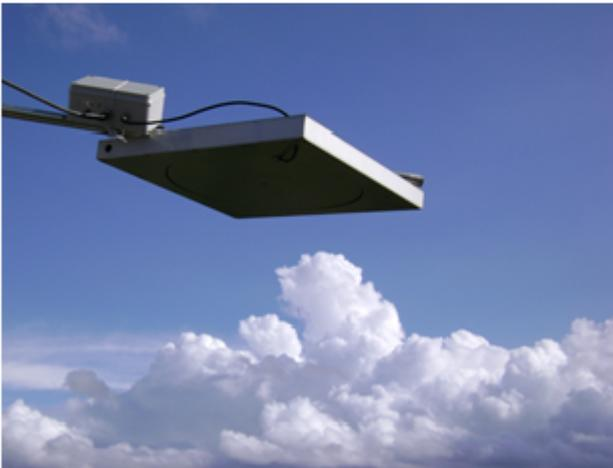
Figura 8 – Sensor de campo elétrico utilizado para o registro da corrente de longa duração.
