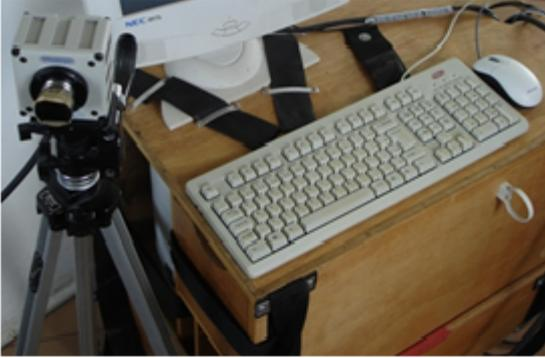
Figura 7 Câmera rápida utilizada para o registro da corrente de longa duração.
