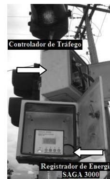
Figura 3. Medições realizadas em semáforos de pedestres com lâmpadas incandescentes antes da substituição.
