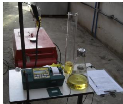
Figura 4. Grupo gerador com os aparatos para teste de emissões
