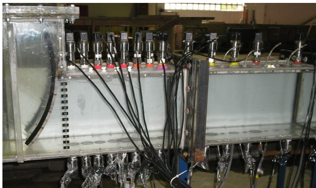
Figura 6 – Instalação dos transdutores de pressão no conduto.
