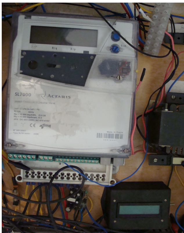
Foto 3: Sistema de calibração com padrão SL7000
