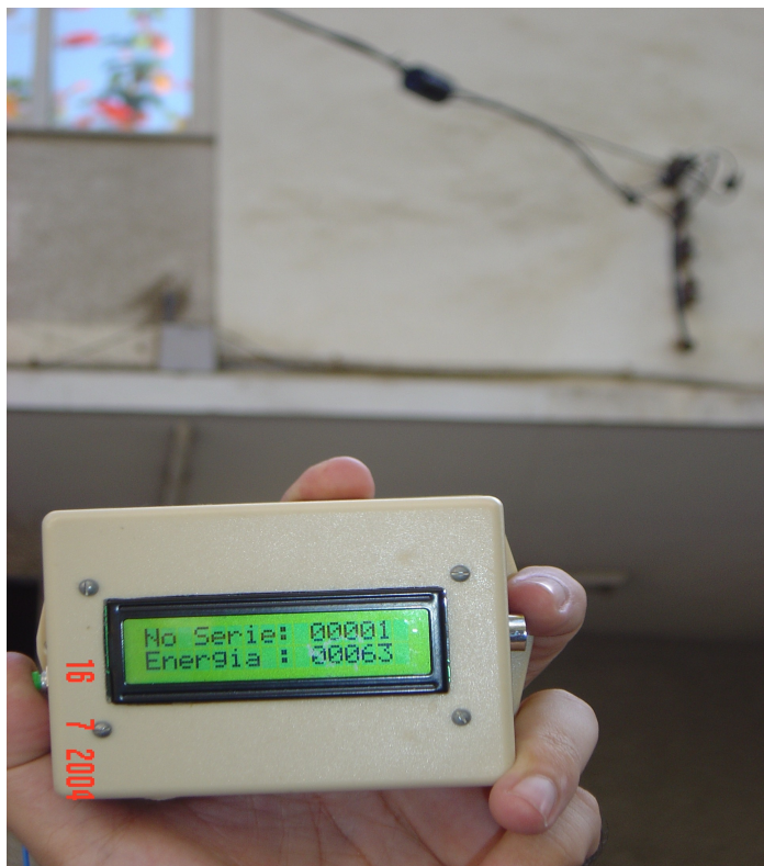
Foto 1: Medidor Anti-Fraude em funcionamento
