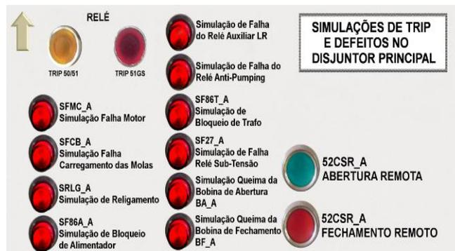
Figura 3. Simulador do disjuntor – Sinalização e Alarmes.
