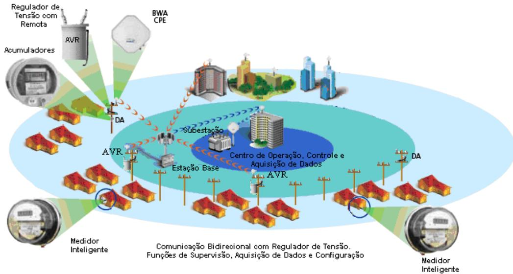
**Figura 12 – Alimentador de Distribuição com controle de tensão em cascata**
