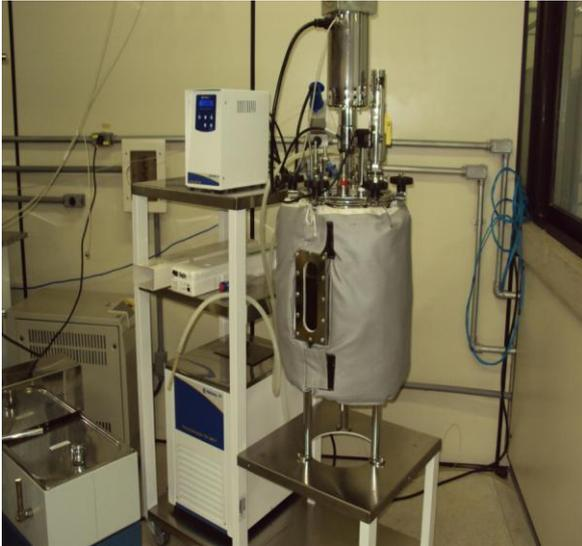
Figura 5: Reator anaeróbico em aço para os processos de biodigestão.
