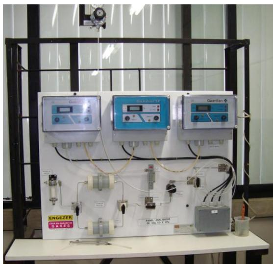
Figura 3 Equipamento para análise dos gases (CO<sub>2</sub>, CH<sub>4</sub>, CO)
