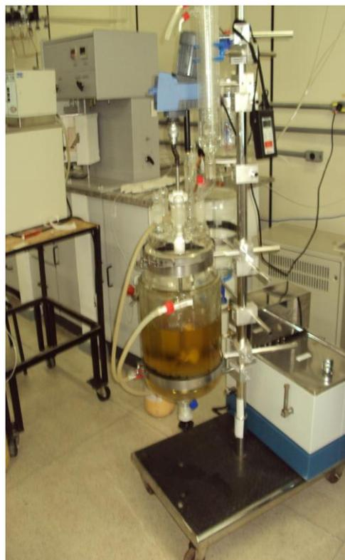
Figura 1: Reator piloto de produção de biodiesel
