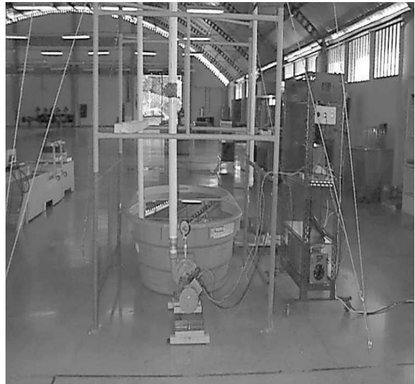
FIGURA 3 (a) –Bancada de testes utilizada para execução dos ensaios da BFT.
